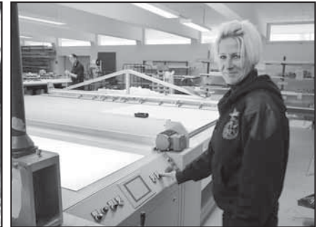
Am Rolloschneidetisch mit Ultraschallverfahren: Ramona Lingsädt (42) aus Berlin-Marzahn
