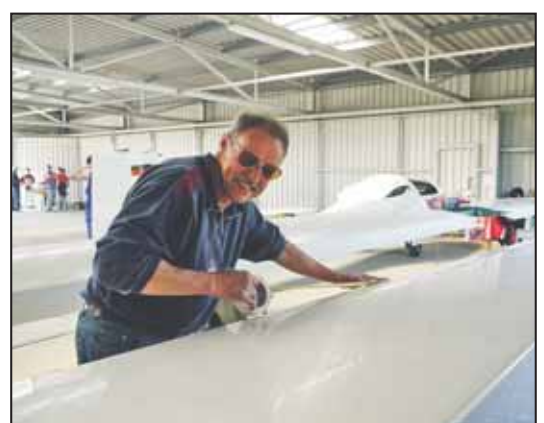
Christoph Sterl macht sich im Hangar an einem Stemme Motorsegler S 10 zu schaffen, um die Flügelunterseiten zu schleifen, zu polieren und dann zu wachsen. Er klebt neue Spaltbänder auf die Querruder.
